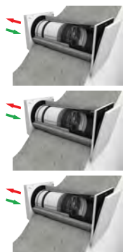
Abluftgeräte im „Sommerbetrieb“
