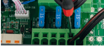
Ausgangsklemmen 36 V (2,5 mm 2 – 6,0 mm 2 )
