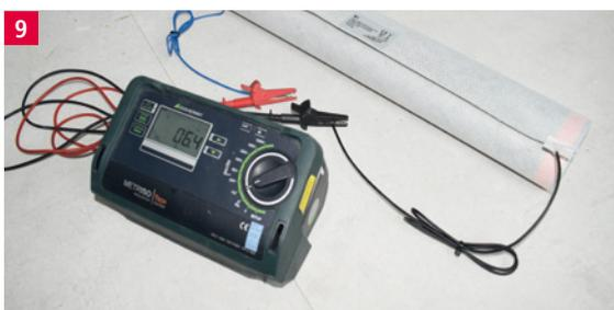
Widerstand gemäß den Widerstandstabellen überprüfen und Werte im Prüfprotokoll und in der Montage-Skizze dokumentieren.
