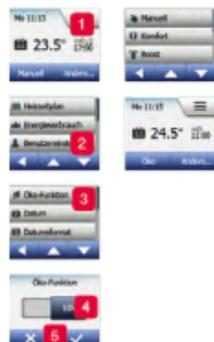
Mit dieser Option wird der Energieverbrauch durch unnötiges Heizen reduziert, wenn der Raum/das Haus während einer planmäßigen Heizphase verlassen wird.
