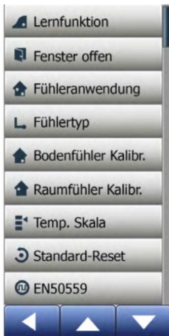
Dieses Menü enthält alle Parameter, die vom Techniker bei der Thermostatinstallation oder Wartung eingestellt werden müssen. Das Menü umfasst folgende Optionen:
