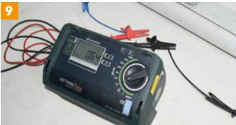
Widerstand gemäß den Widerstandstabellen überprüfen und Werte im Prüfprotokoll und in der Montage-Skizze dokumentieren.
