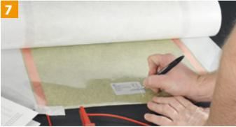
Widerstände zugeschnittener Folien erneut messen und auf Etikett, im Prüfprotokoll und der Montage-Skizze dokumentieren – Sollwerte den Widerstandstabellen entnehmen.
