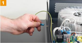
1 Schutzleiter am Gehäusedeckel anschließen.
