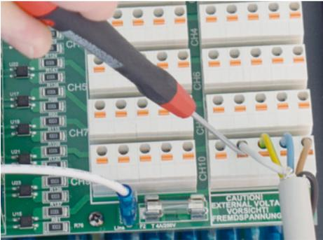
Raumthermostat anschließen, Kabel 5x1,5 mm<sup>2</sup>
