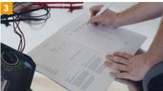
3 Widerstände erneut messen und im Prüfprotokoll sowie der Montage-Skizze dokumentieren. Sollwerte der Montageanleitung entnehmen.
