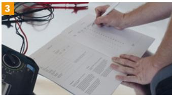
Widerstände erneut messen und im Prüfprotokoll sowie der Montage-Skizze dokumentieren. Sollwerte der Montageanleitung entnehmen.
