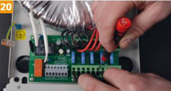
Zuleitungen am Netzteil anschließen.
