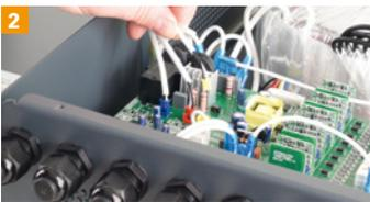
2 Steckverbindungen der LED-Anzeige (grün, rot, gelb) mit dem richtigen LED-Anschluss anschließen.
