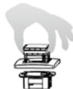
Zum Einführen oder Entfernen eines flexiblen Drahtes den Betätiger eindrücken.
