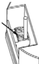
Die Drähte müssen so montiert werden, dass der Kunststoffstreifen als Isolation zur Befestigungsschraube wirkt.
