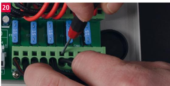
Zuleitungen am Netzteil anschließen.
