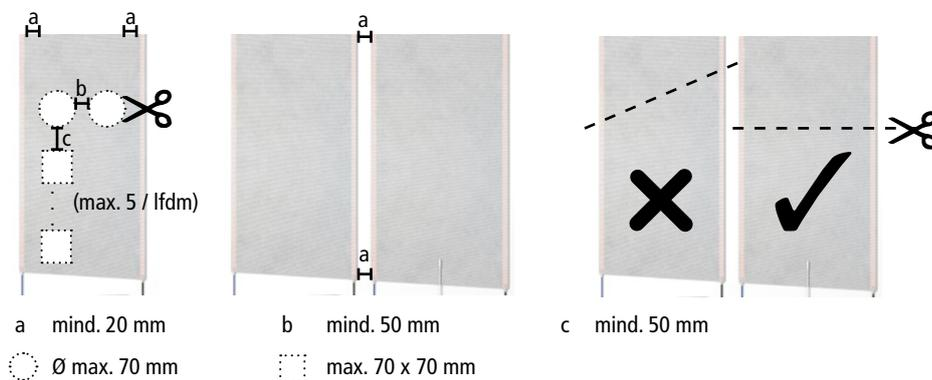
**Hinweis:** Beachten Sie, dass Schrauben nur dann in die Heizfläche eingebracht werden dürfen, wenn diese mit Kunststoffdübeln zur elektrischen Isolation installiert werden. Zusätzlich dürfen zwei Schrauben nicht mit einem elektrisch leitfähigen Material (z.B. Metallbilderrahmen, Metallzierleiste, Regalsystem aus Metall) verbunden werden. Das Durchbohren des Kupferstreifens sowie die Verwendung von Nägeln ist nicht zulässig.
