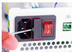
Interne Trafosicherung tauschen
